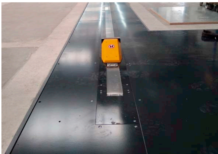
Fließmontagelinie mit zentralem Taktantrieb für synchronen Vorschub aller Montagestationen
