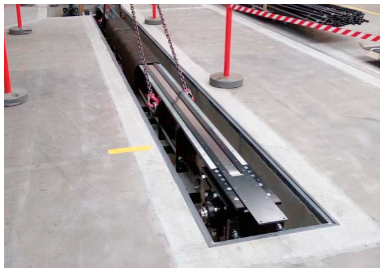
Fließmontagelinie mit zentralem Taktantrieb für synchronen Vorschub aller Montagestationen
