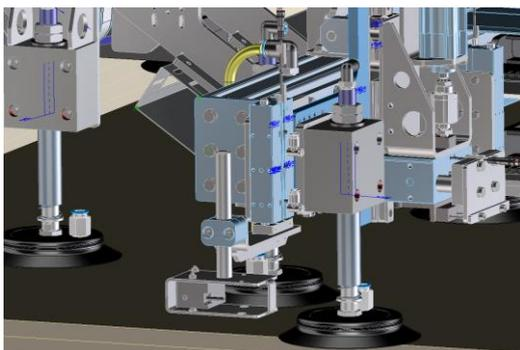
Das Flächenlager wird zur Beschickung einer Plattensäge eingesetzt, das automatische Um-, Aus- und Einlagern von Plattenware ist eine Standardfunktion.
